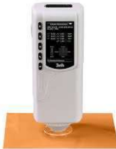
Слика број 7.2. Колориметар NR100 Precision Colorimeter који је коришћен у овом истраживању
